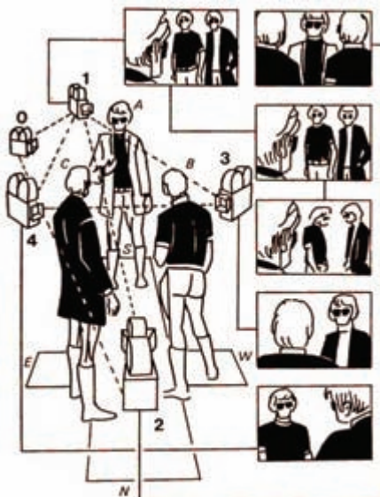
FIGURE 6.37 Une ligne d'intérêt nord-sud se déplace pour devenir une ligne d'intérêt dominante est-ouest. Quatre positions principales de la caméra sont utilisées et sont toutes des prises en contre-champ externe. La position 1 est choisie pour l'emplacement de la caméra, dès que l'on a constaté le changement de ligne de direction.
